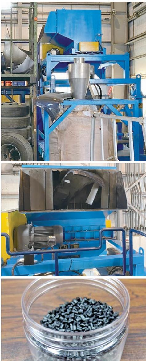
粗破碎洗浄粉砕脱水ユニット(上)の投入口(中)に自動車の大型樹脂成型品を入れると樹脂チップ(下)が出来上がる
