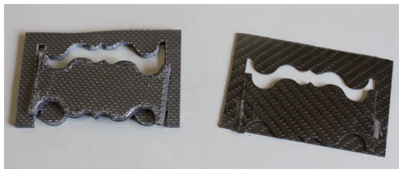
新工法によるカーボン試作品(左:従来技術/右:新技術)
