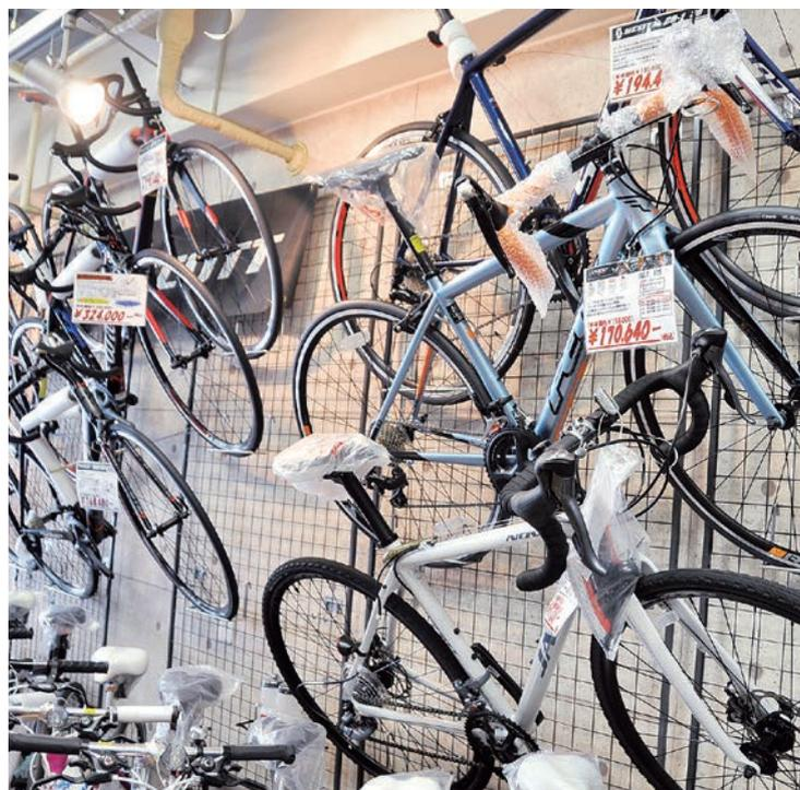
ロードバイクのタイヤは高速走行用に細く、円弧を描いたようなドロップハンドルが特徴。前傾姿勢でスピードを出しやすい。クロスバイクは平行なハンドルで、舗装路以外でも走りやすい。
