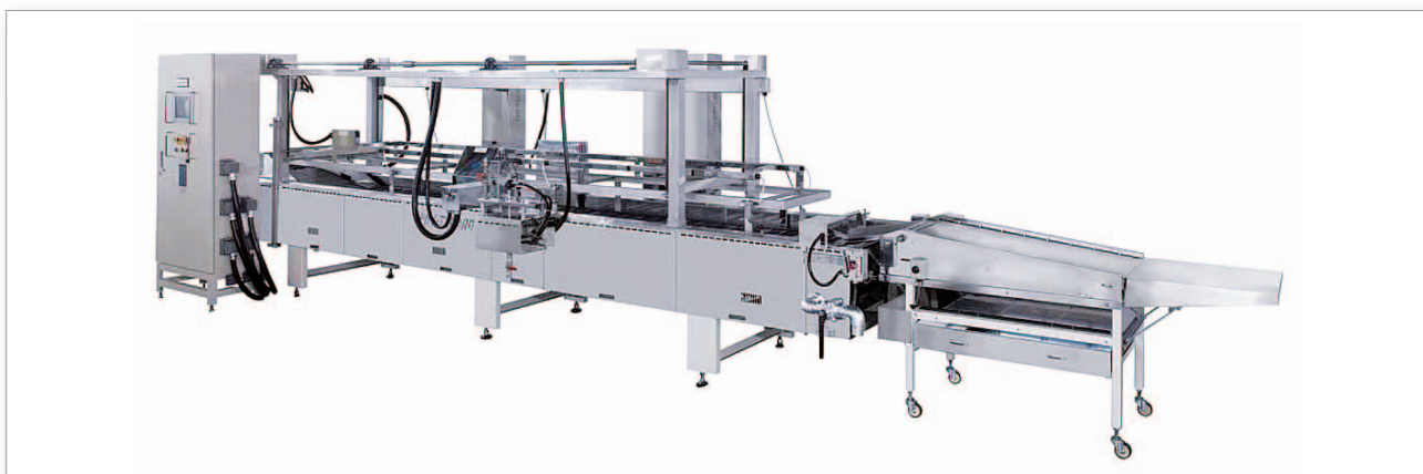
●FI型・・・「誰でも、簡単に、間違いのない操作＝安心・安全」がコンセプトのイーストドーナツ・ケーキドーナツ兼用機
