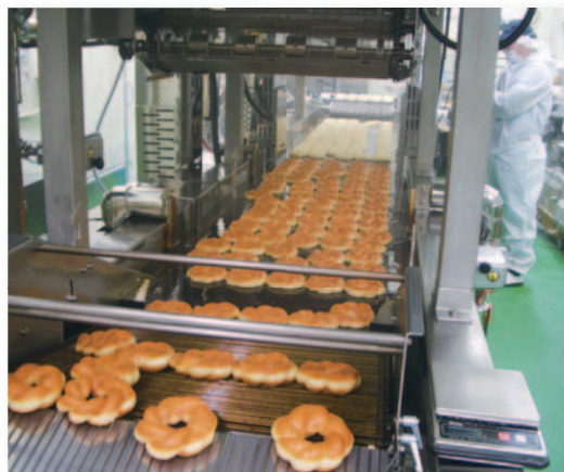
●ドーナツが流れるドーナツフライヤー 成形したドーナツ生地をフライヤーに流すと、中央で反転し両面が均等にぎつね色に揚がる
